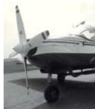
Eine der BAeC-Umweltmassnahmen: 4-Blatt Propeller und Schalldämpfer zur Reduktion des Schallpegels.
